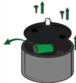
Para substituir a bateria do produto remova os parafusos do compartimento que se encontra na Cabeça da Luminária e remova a bateria. Faça a substituição por uma bateria recarregável com as mesmas especificações (2/3 AA Ni-Mh 1,2V 150mAh).
